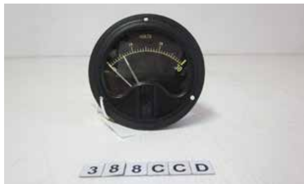
Voltmètre de tableau de bord d'avion (vers 1950) : peinture verte à base de radium et/ou de tritium © Musée de l'Air et de l'Espace, Le Bourget
