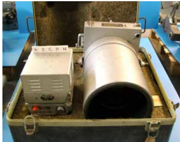
Caméra américaine K37 avec objectif Aero-Ekta pour avion : contient de l'oxyde de thorium. © Musée de l'Air et de l'Espace, Le Bourget
