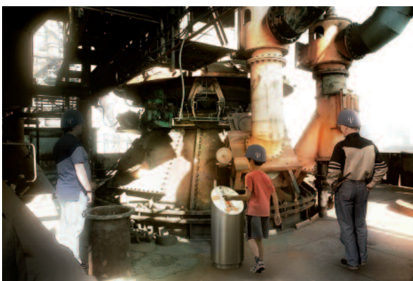
Sur un parcours de visite, le public découvrira les principaux éléments du processus de la fonte. La station gueulard, où se faisait l'alimentation du haut fourneau, est située à une hauteur de 40 m et sera accessible par ascenseur.
